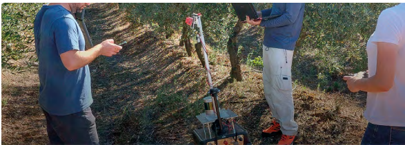
Figura 6 – Robô terrestre autónomo (em cima) e robô aéreo – drone (em baixo) – para recolha de amostras visuais das copas das oliveiras
