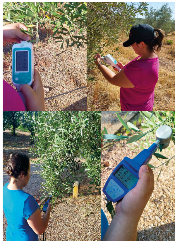
Figura 10 – Medições não destrutivas com o porómetro/fluorómetro LI-600 (em cima) e o Dualox (em baixo) em folhas de oliveira ( Olea europaea L.)
