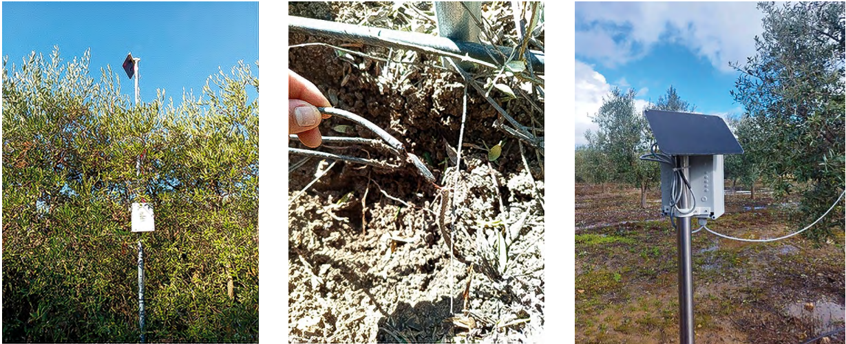
Figura 8 – Sondas de monitorização de parâmetros no solo (detalhe do módulo de registo e emissão de dados, equipado com painel solar para alimentação elétrica, e cabos de ligação entre a unidade de aquisição de dados e os sensores inseridos no solo); em baixo, um gráfico gerado pelos sensores capazes de fazer leituras dos níveis de macronutrientes N, P e K, ao longo da campanha de 2025
